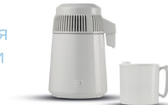
Позволяет получить дистиллированную воду за счёт кипячения с последующей конденсацией пара. Производит 700 мл воды в час. Объём 4 литра. Прошёл испытания на безопасность и электромагнитную совместимость (2014/30/UE), а также низкое напряжение (2014/35/UE).
